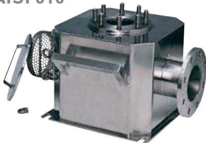
Prefiltros en Inox para el filtrado de sólidos en suspensión. Colocados en la aspiración de las bombas recirculadoras, previenen el bloqueo de las turbinas. El sistema de fijación de las tapas permite un fácil acceso a la cesta para realizar su limpieza.
