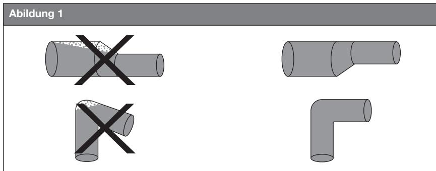
Die Rohre müssen so installiert werden, dass die durch Temperaturschwankungen verursachten mechanischen Spannungen das Funktionieren der Pumpe nicht beeinträchtigen.
