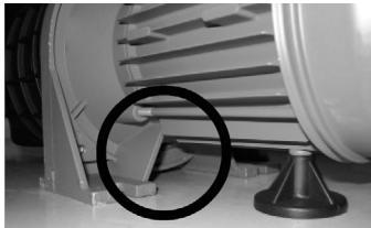
Regelmäßige Kontrolle auf Dichtheit! (Bei undichter Gleitringdichtung schwere Folgeschäden!)
