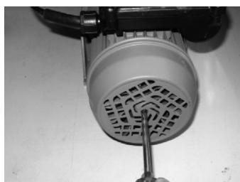
С целью предотвращения блокировки механического запора, перед запуском или после продолжительное неиспользование насоса повернуть ось через вентилятором.
