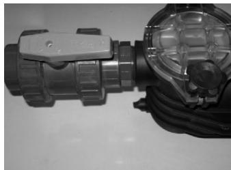
Запуск насоса только при открытый разгрузочный клапан.
