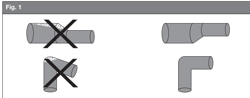
Las tuberías deben montarse de forma que las tensiones causadas por variaciones de la temperatura no afecten a la bomba.
