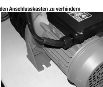
FALSCH! Wasser gelangt über das Kabel in den Anschlusskasten
